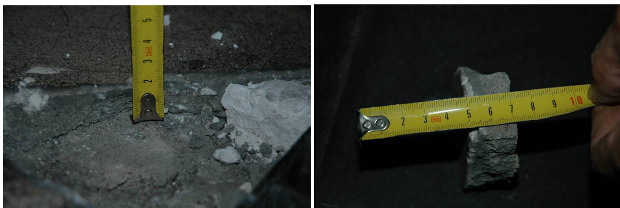
Fot. 56,57 Przekrój płytki o grubości 20mm. Wierzchnia warstwa z 3-5mm barwionej szklawionej masy, 5mm wzmocnionej warstwy cementowej oraz 10mm słabszej warstwy cementowej z droбноziarnistym kruszywem. Stare płytki wymienić na jednokolorowe barwione w masie.
